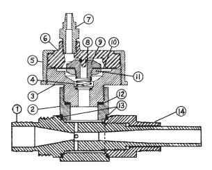
EJECTOR MODEL A-926 500 PPD (10 kg/hr.)
