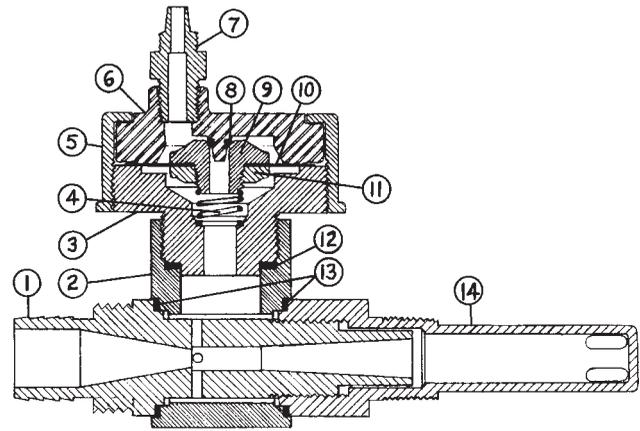
EJECTOR MODEL A-921 100 PPD (2000 g/hr.)
