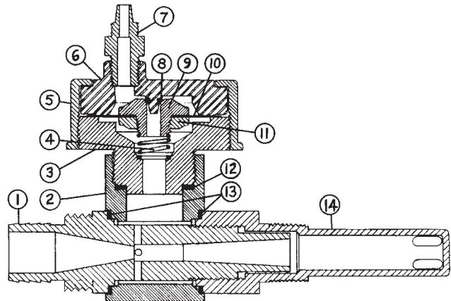
EJECTOR MODEL A-921S 100 PPD (2000 g/hr.)
